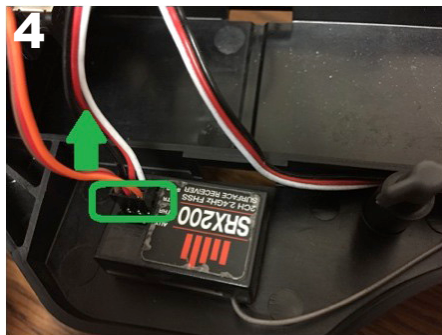
En tirant droit dessus, déconnectez le contrôleur du récepteur (le récepteur est marqué THR).
